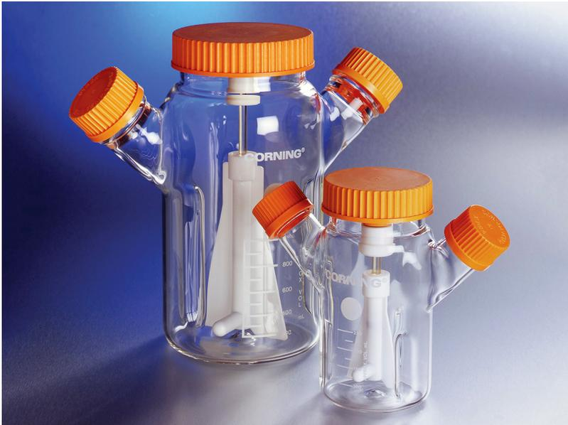
Одноразовые биореакторы на 1 000 миллилитров выполнены из боросиликатного стекла и применяются для получения суспензионных культур. Встроенный элемент перемешивания обеспечивает эффективное смешивание содержимого колбы и оптимальный процесс аэрации. Доступ в колбу обеспечивается через два боковые входные отверстия для пипеток объемом 25 и 50 миллилитров. Колпачки винтового типа изготовлены из полипропилена оранжевого цвета.
