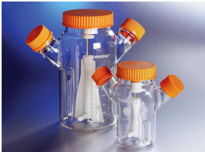
Одноразовые биореакторы на 250 миллилитров из боросиликатного стекла разработаны для получения суспензионных культур. Конструкция встроенного элемента перемешивания обеспечивает эффективное смешивание содержимого ёмкости и оптимизирует процесс аэрации. Доступ в колбу возможен через два боковых входных отверстия посредством пипеток на 25 и 50 миллилитров. Полипропиленовые колпачки винтового типа в оранжевом цвете. Устройство прошло стерилизацию гамма-облучением.
